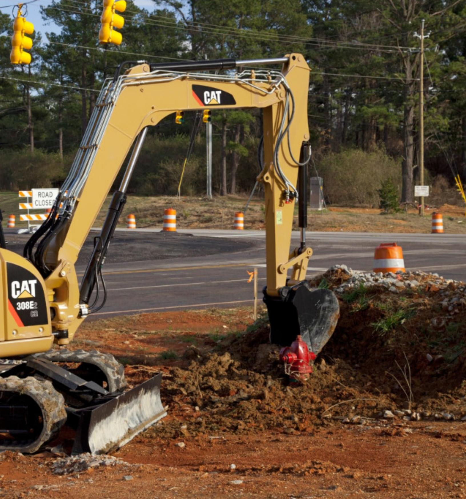
La Minipelle hydraulique 308E2 CR SB Cat offre des performances élevées conjuguées à la polyvalence d'une timonerie avant à flèche orientable dans une conception à rayon réduit robuste, afin de vous permettre de travailler dans les applications les plus étroites. Avec le panneau d'affichage COMPASS, le moteur Tier 4 Final et le nouveau circuit hydraulique, la 308E2 CR SB est plus productive, plus polyvalente et plus rentable.
