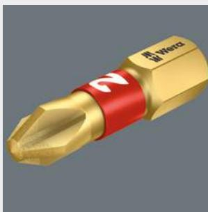
Les embouts constituent le très haut de gamme. Ils sont dotés d'une zone BiTorsion plus tendre, le corps de l'embout présentant une dureté environ 20 % inférieure à celle de la pointe d'attaque. Le gauchissement de la pointe de l'embout lors des pics de contrainte est pour une large part évité, ce qui accroît davantage encore la durée
