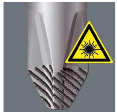
À l'aide d'un laser extrêmement concentré, on génère une structure superficielle acérée. La dureté des stries réalisés par ce procédé atteint jusqu'à 1000 HV 0,3. Wera Lasertip s'agrippe dans la tête de vis et empêche le dérapage hors de celle-ci. Pour vis à fente, Phillips et Pozidriv.
