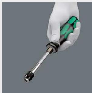
Grâce à l'adaptateur, les manches à admission 6 mm peuvent également entraîner des sections hexagonales ou carrées 1/4" répondant aux normes DIN ISO 1173-C 6,3 et DIN 3120.
