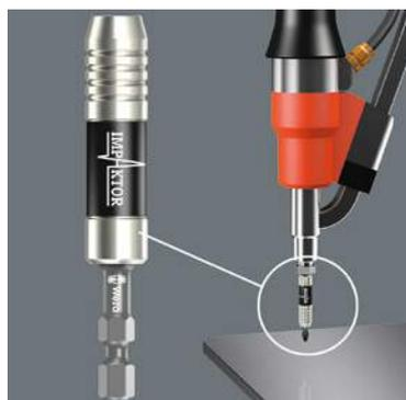
Le porte-embouts Impaktor en acier inoxydable avec jonc d'arrêt et aimant répond aux exigences dynamiques extrêmes en renonçant délibérément aux petits composants plus sensibles sur le plan mécanique. Il se concentre sur la fonction primordiale de maintien de l'embout et l'amortissement des pics d'impulsion extrêmes grâce à deux zones « torsion » différentes. Emploi surtout en vissage industriel robotisé par ex.
