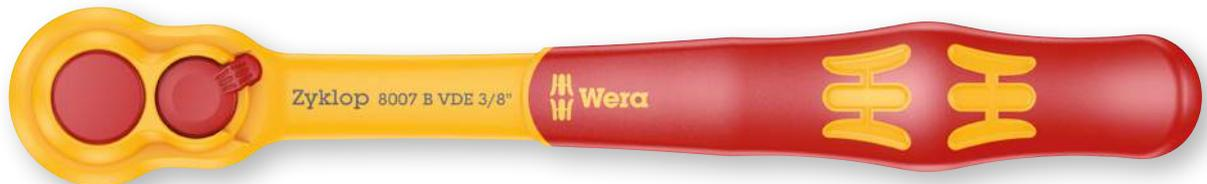
Le contrôle unitaire sous 10.000 Volt des outils Zyklop VDE, selon l'IEC 60900, garantit la sécurité du travail jusqu'à 1.000 Volt.
