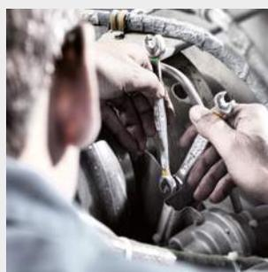
La double fourche Joker se prête idéalement au (contre-)serrage de vis et d'écrous.
