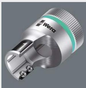
Le maintien de la vis hexagonale dans la douille à carré est assuré par deux billes élastiques et une gaine thermorétractable haute résistance à élasticité permanente. Celle-ci est protégée contre les endommagements mécaniques par une collerette d'acier située à l'avant. Particulièrement utile dans les espaces de travail d'accès
