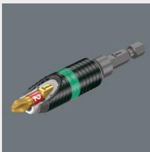
Les porte-embouts BiTorsion, convient à tous les embouts de types C 6,3 et E 6,3, possèdent un ressort de torsion qui absorbe les pics de contrainte mineurs lors du vissage. Leur utilisation conjointe avec les embouts BiTorsion et leur zone de torsion prolongent sensiblement la durée de vie de l'outil. Les
