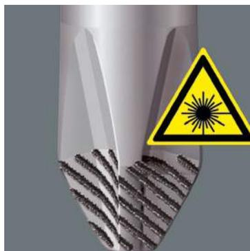
Le traitement laser de la pointe des lames présente une surface micro-rougeuse avec des duretés latérales pouvant aller jusqu'à 1 000 vickers, qui vient littéralement « mordre » dans la tête de la vis. Avantage : moins de dérapage, plus de sécurité.
