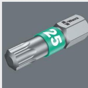
Les embouts BTZ sont dotés d'une zone BiTorsion obtenue par trempe du corps pour obtenir une dureté environ 20 % inférieure à celle de la pointe d'attaque. Le gauchissement de la pointe de l'embout lors des pics de contrainte est en grande partie évité, ce qui accroît davantage encore la durée de vie des embouts.
