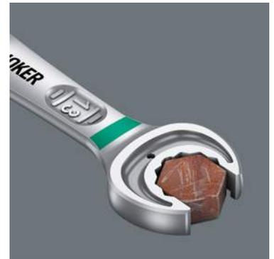
L'ingénieuse géométrie dodécagonale de Joker engendre une liaison géométrique intime avec la vis ou l'écrou – une liaison qui tient ! Et la plaque interchangeable en métal trempé située dans la fourche de Joker « enserre » littéralement la vis de ses pointes extrêmement dures. Deux atouts permettant d'éviter tout dérapage malencontreux, même lors de serrages avec couples élevés.
