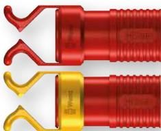
**Utilisation :** outil emboîtable ayant pour fonction de retenir les vis ; maintient à coup sûr les vis de tout profil et de toute taille sur l'outil ; convenant pour lames cylindriques et hexagonales de 4,5 à 6,0 et de 6,0 à 8,5 mm de diamètre
