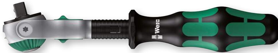
La tête du cliquet est librement orientable et peut être déverrouillée en toute position grâce au bouton coulissant positionné sur les 2 côtés. Travail sans problème et avec une grande liberté de manœuvre, même dans les endroits très exigus ou difficiles d'accès. Les positions de blocage définies à 0°, 15° et 90° à gauche et à droite garantissent un travail sûr et empêchent la tête de riper.
