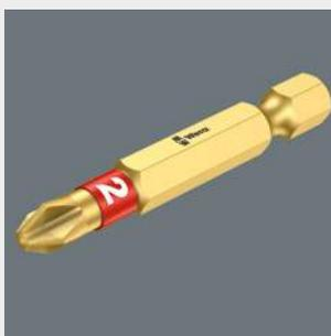
Les embouts BDC constituent le très haut de gamme. Ils sont dotés d'une zone BiTorsion plus tendre, le corps de l'embout présentant une dureté environ 20 % inférieure à celle de la pointe d'attaque. Le gauchissement de la pointe de l'embout lors des pics de contrainte est pour une large part évité, ce qui accroît davantage encore la
