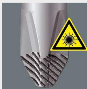
Le traitement laser de la pointe des lames présente une surface microrugueuse avec des duretés latérales pouvant aller jusqu'à 1 000 vickers, qui vient littéralement « mordre » dans la tête de la vis. Avantage : moins de dérapage, plus de sécurité.
