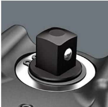
L'inversion de sens via le carré mâle traversant garantit une résistance très élevée, du fait de la disparition du mécanisme de commutation classique susceptible d'être détruit par le martèlement.
