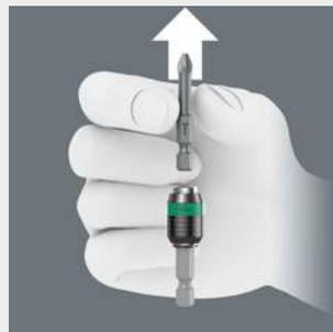
Pour échanger l'embout, il suffit de faire coulisser la douille vers l'avant : le mécanisme à ressort décolle ce faisant l'embout de l'aimant et déverrouille l'outil. L'embout peut être retiré sans problèmes. Particulièrement utile : retrait des embouts même de tout petit calibre sans aucun outil auxiliaire.
