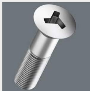
Le système de vissage TRI-WING® est surtout utilisé dans le domaine de l'aéronautique et l'électromécanique (ici notamment sur les éléments sous tension). La disposition asymétrique des trois flancs du profilé empêche toute utilisation d'autres outils que les outils originaux. Le profilé ultra-précis Wera garantit un positionnement sûr de
