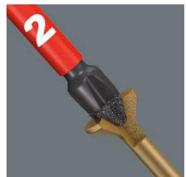
Les particules de diamant réduisent les forces de rejet particulièrement élevées engendrées lors du vissage mécanique, susceptibles d'entraîner un dérapage hors de la vis. Les particules de diamant viennent « mordre » dans la vis, d'où une diminution de la force de compression nécessaire. Résultat : l'apparition de fatigue physique en vissage mécanique est nettement retardée.
