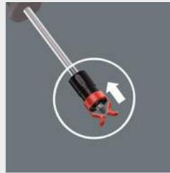
Faire glisser l'agrippe-vis sur la pointe de la lame du tournevis jusqu'à ce que le profil de la lame ressorte du manchon en caoutchouc.
