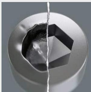
Le problème des vis à six pans creux tient à la minceur des surfaces d'appui sur lesquelles s'opère la transmission de la force depuis l'outil. Résultat : la tête de vis peut être endommagée. Les outils Hex-Plus possèdent des surfaces d'appui plus larges qui empêchent ce problème. Bon à savoir: les outils Hex-Plus s'utilisent sur toutes les vis à six pans creux standard !
