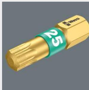
Les embouts BDC constituent le très haut de gamme. Ils sont dotés d'une zone BiTorsion plus tendre, le corps de l'embout présentant une dureté environ 20 % inférieure à celle de la pointe d'attaque. Le gauchissement de la pointe de l'embout lors des pics de contrainte est pour une large part évité, ce qui accroît davantage encore la durée
