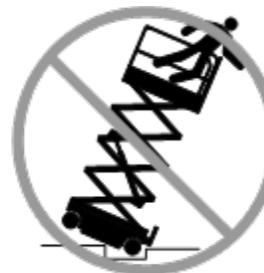
Faire preuve d'une extrême prudence et rouler lentement en conduisant la machine en position repliée sur un terrain irrégulier, des débris, des surfaces meubles ou glissantes ou près de trous et de dévers.
