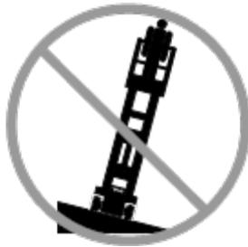
Ne pas se fier à l'alarme de dévers pour indiquer le niveau. L'alarme de dévers retentit sur le châssis uniquement lorsque la machine se trouve sur une pente à forte inclinaison.
