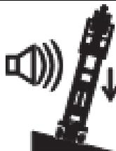
L'écran à DEL des commandes de la nacelle affiche « LL », l'écran à cristaux liquides des commandes au sol affiche « LL: Machine Tilted » (LL : Machine inclinée) et l'alarme de dévers retentit à 180 bips par minute. Fonctions affectées : les fonctions de translation, de direction et d'élévation sont désactivées.
