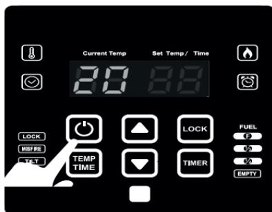
2. Sélectionnez le mode de contrôle de la température en appuyant sur le bouton Temp/Time. Le voyant de contrôle de la température s'allume alors.
