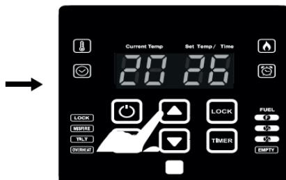
3. Selecteer de gewenste herhalingstijd door op de T--knop te drukken. Wanneer u de herhalingstijd verhoogt of verlaagt door op de T+-knop te drukken, knippert de tijd, en als u de knop 3 sec. niet indrukt, wordt deze weergegeven knippertijd ingesteld als 'Herhalingstijd'. Op dat moment wordt de eerdere herhalingstijd automatisch gewist.
