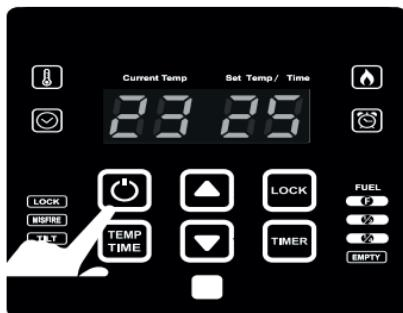
2. sélectionner le mode de fonctionnement souhaité à l'aide du bouton "temp/time".
