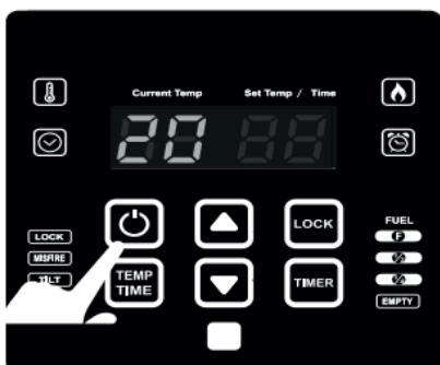
5. Lorsque la température réglée est supérieure de 2°C par rapport à la température ambiante, l'appareil commence à fonctionner et lorsque la température réglée est inférieure à 1 °C par rapport à la température ambiante, l'appareil s'arrête.
