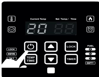
2. Sélectionnez le mode de contrôle de l'heure en appuyant sur la touche Temp/Time. Le témoin de contrôle de l'heure s'allume alors.
