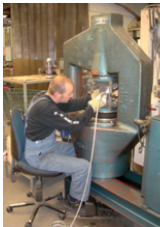
Serissage des élingues en câble dans nos ateliers
