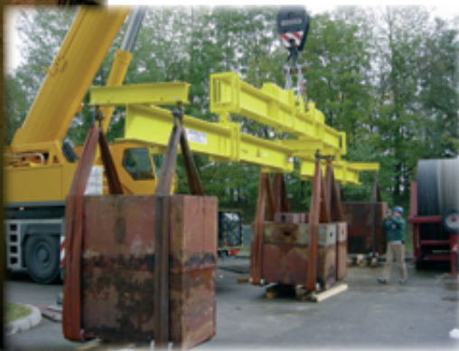
Essais en surcharge à 52 tonnes (150%). (CERN, Genève 2005)
